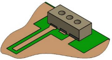
ANTENNA ON FOOTPRINT PCB VIEW SCALE 4:1
